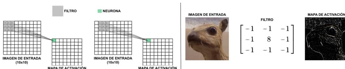
Figura 4-1: Las dos primeras iteraciones del proceso de convolución (izquierda) [33] y resultado de la convolución de una imagen con una matriz detectora de bordes (derecha) [11].
